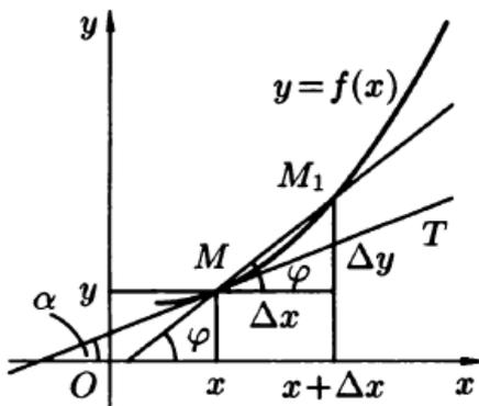
Рисунок 5 - Геометрический смысл производной
